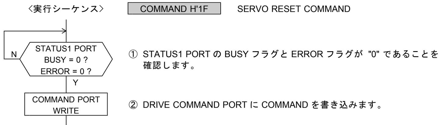
コマンドの実行で、DRST 信号出力に 10 ms 間アクティブレベルを出力します。
