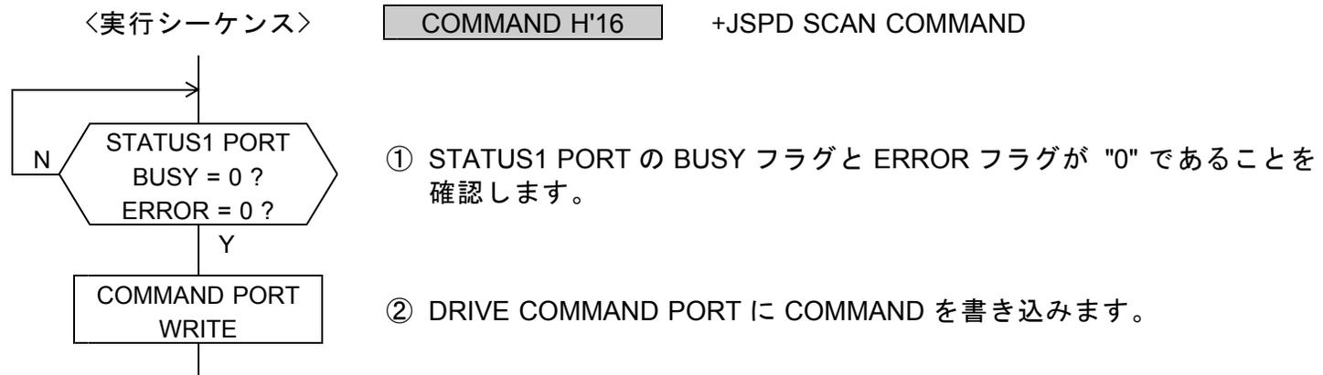
停止指令を検出するまで、JSPD の一定速度で、- (CCW) 方向のパルスを連続して出力します。
