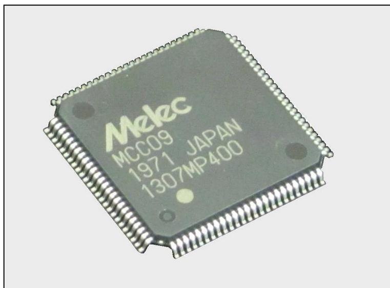
ステッピング & サーボモータチップコントローラ
