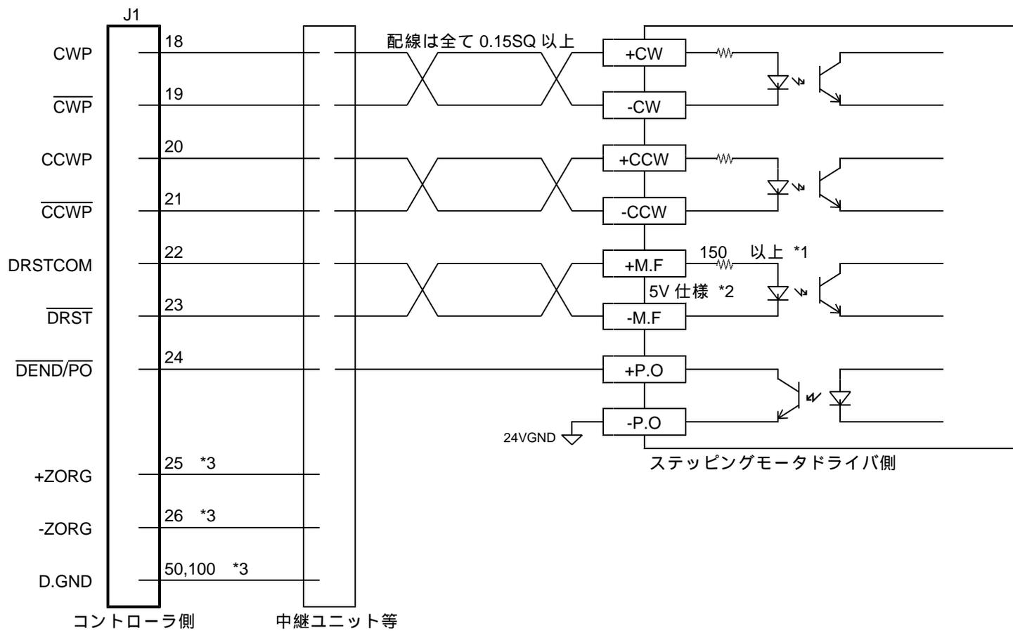
\*1 ドライバ側入力回路の電流制限抵抗が 150 Ω 以下の場合、外部で抵抗を付け 150 Ω 以上にしてください。
