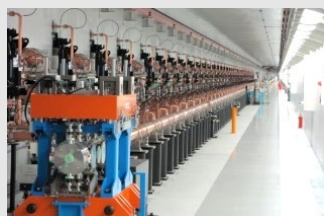
SACLA 施設内 電子を光速近くまで加速する 加速管周辺
