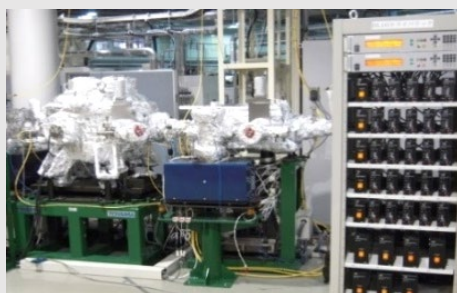
偏光可変アンジュレータビームライン (BL10) 分光器および制御システム
