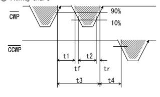
$t1 \ge 2 \mu s$ ,  $t2 \ge 2 \mu s$ ,  $tf, tr \le 2 \mu s$  $t3 > 4 \mu s$ ,  $t4 > 4 \mu s$
