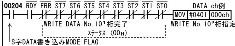
【WRITE DATA読み出しMODEのINDEX No. 10<sup>1</sup>桁指定完了を条件に取る場合】
