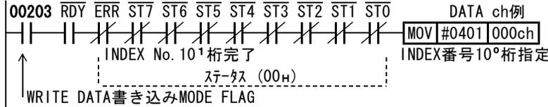
【S字DATA書き込みMODEのDATA No. 10<sup>1</sup>桁指定完了を条件に取る場合】
