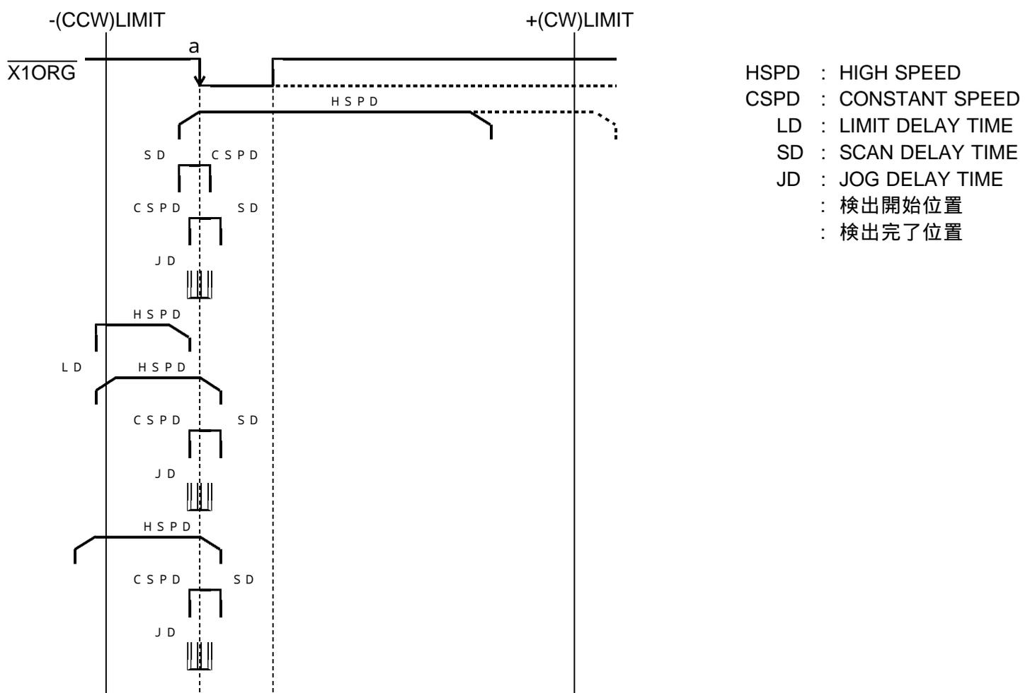
1つのセンサで行う型式です。 $\overline{X1ORG}$ 信号の-(CCW)側エッジ(a点)を検出します。ORGセンサは、1つのパルス又は、+(CW)側レベル保持のものを使用します。
