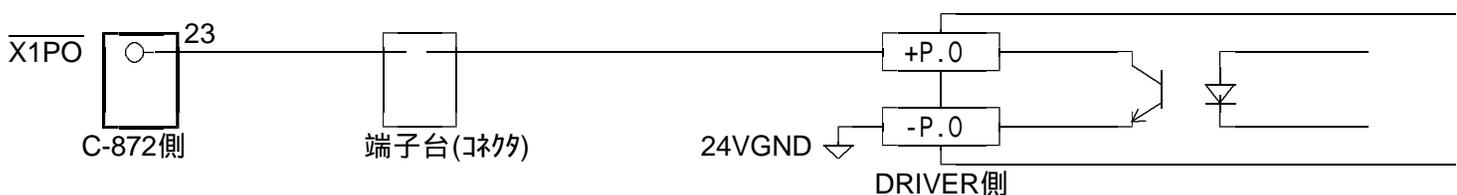
STEPPING DRIVERの場合、 $\overline{X1DRST}$ ,  $+X1ZORG$ ,  $-X1ZORG$ は必ず未接続として下さい。励磁出力を使用しない場合は、 $\overline{X1PO}$ も未接続にします。
