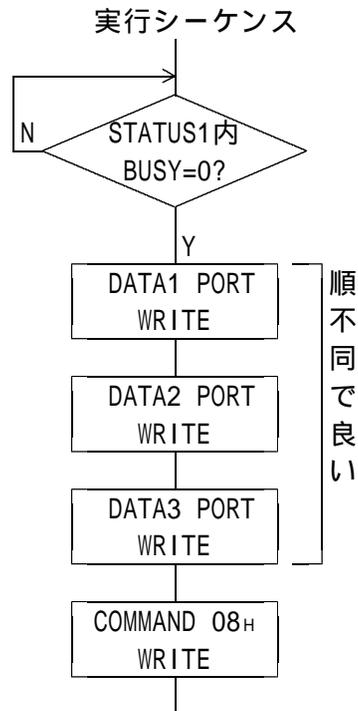
DRIVE DATA1,2,3 PORTにHSPDをHz単位の3バイトDATAで設定します。
