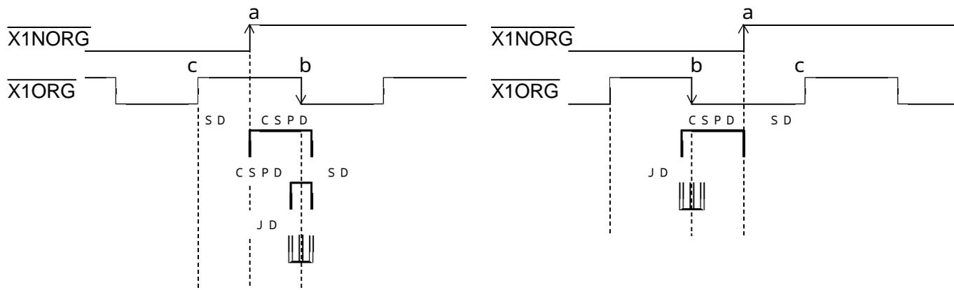
2つのセンサで行う型式です。 $\overline{X1NORG}$ 信号の+(CW)側エッジ(a点)を検出した後、 $\overline{X1ORG}$ 信号の-(CCW)側エッジ(b点)を検出します。NORGセンサは、1つのパルス又は-(CCW)側レベル保持のもの、ORGセンサは回転軸のスリット等周期的に信号発生されるものを使用します。
