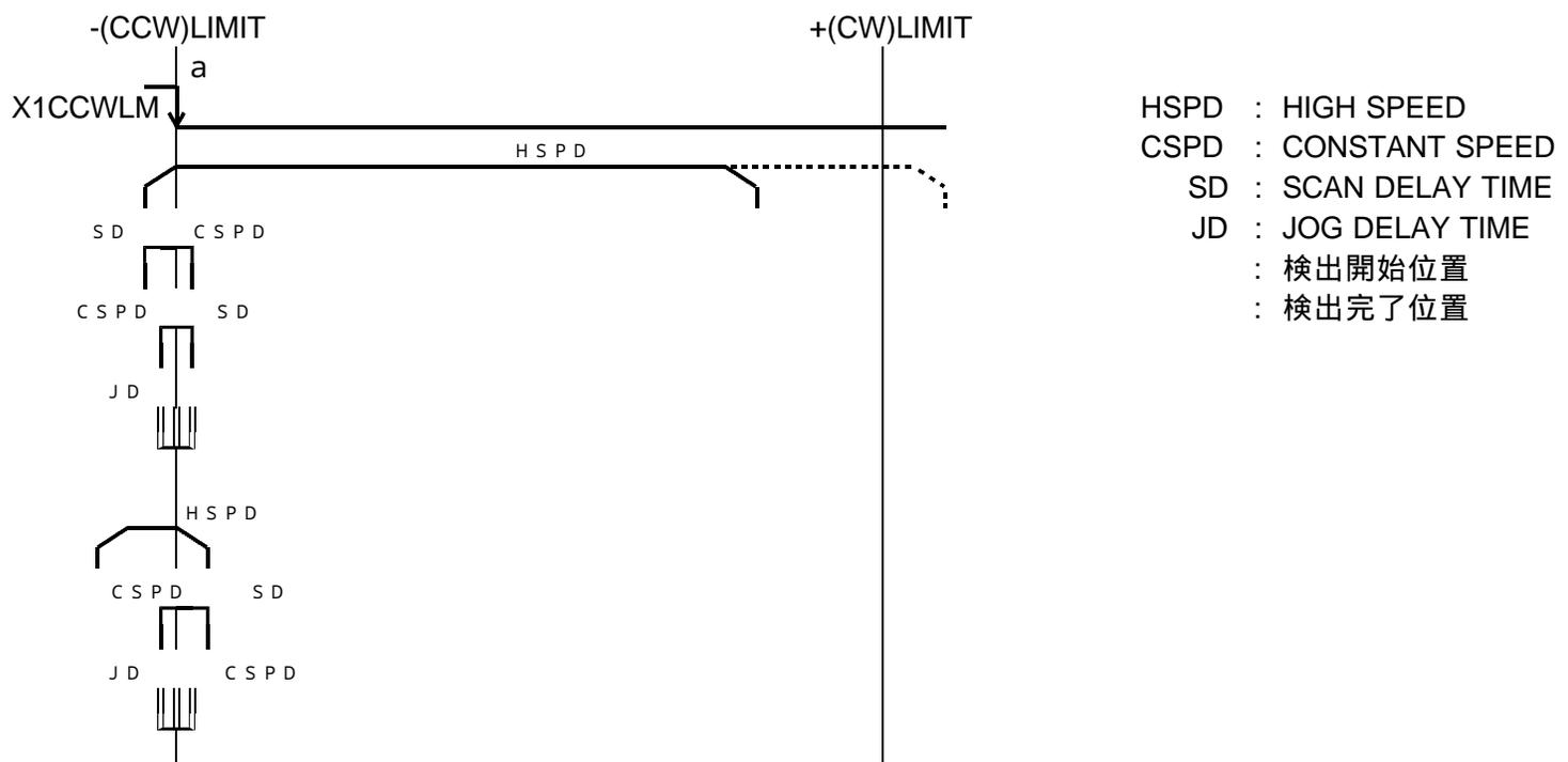
1つのセンサで行う型式です。X1CCWLM信号の+(CW)側エッジ(a点)を検出します。ORGセンサとして、-(CCW)LIMITセンサを使用します。X1CCWLM信号は、1つのパルス又はレベル保持のものを使用して下さい。ORG-11型式とは、最終工程が繰り返しのJOG DRIVEとなっている点が異なります。
