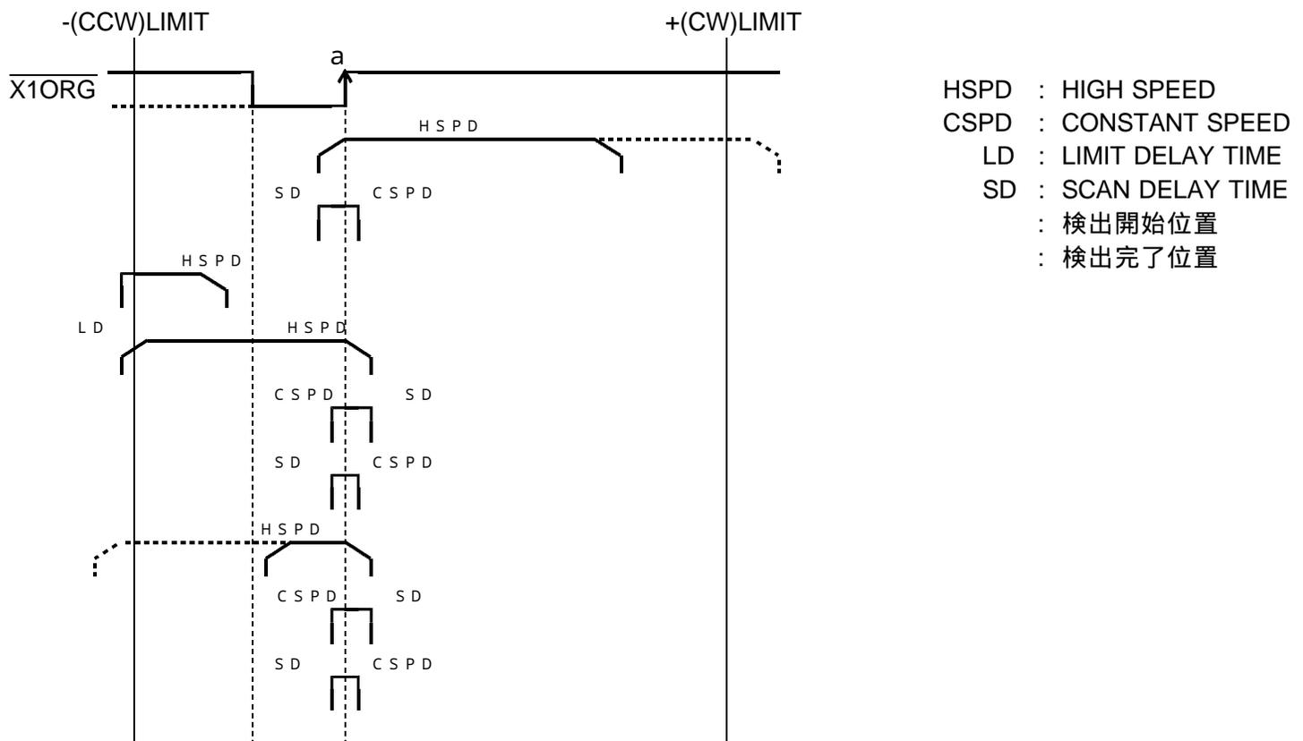
1つのセンサで行う型式です。 $\overline{X1ORG}$ 信号の $+(CW)$ 側エッジ(a点)を検出します。ORGセンサは、1つのパルス又は、 $-(CCW)$ 側レベル保持のものを使用します。
