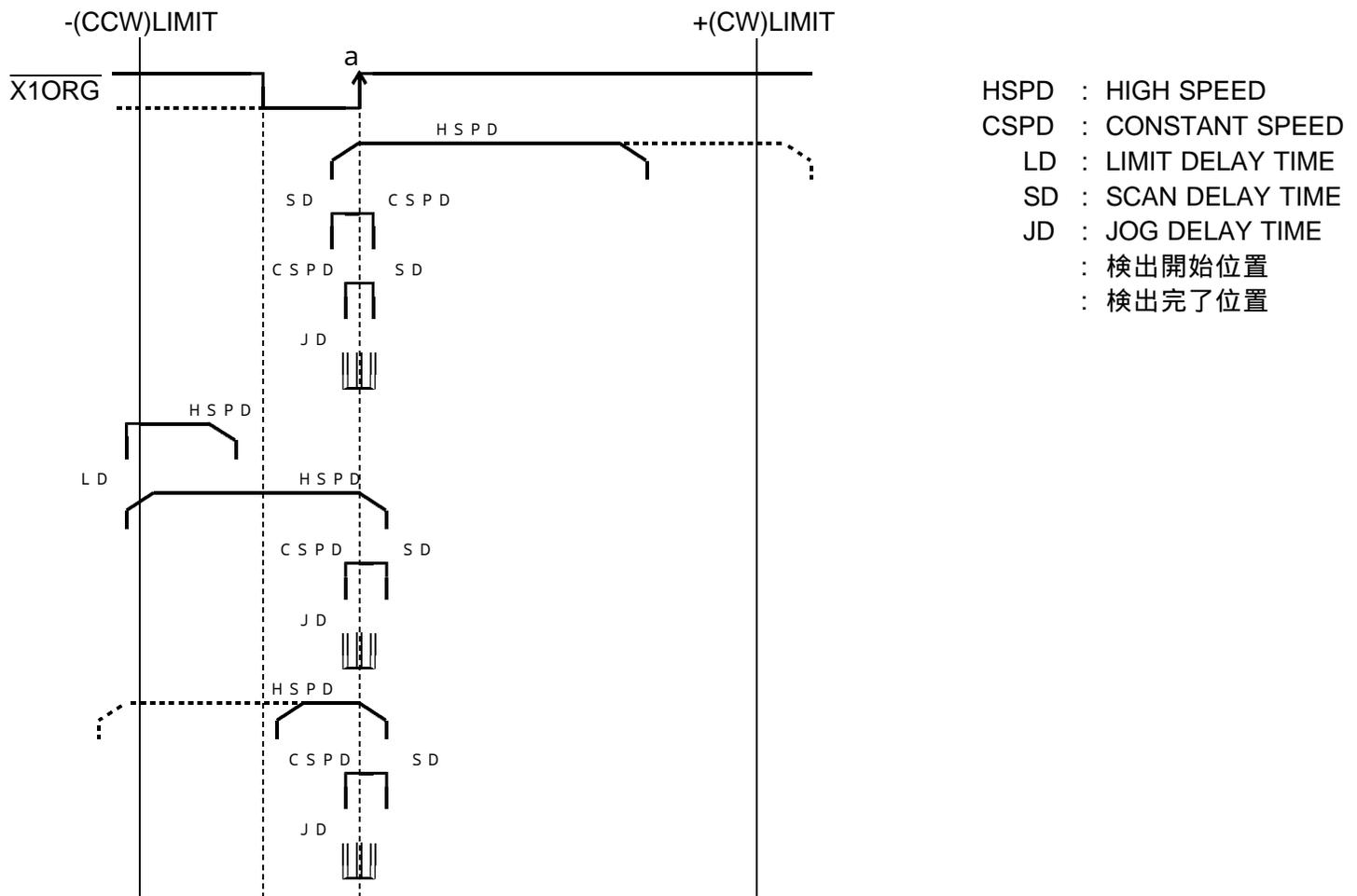
1つのセンサで行う型式です。 $\overline{X1ORG}$ 信号の+(CW)側エッジ(a点)を検出します。ORGセンサは、1つのパルス又は、-(CCW)側レベル保持のものを使用します。
