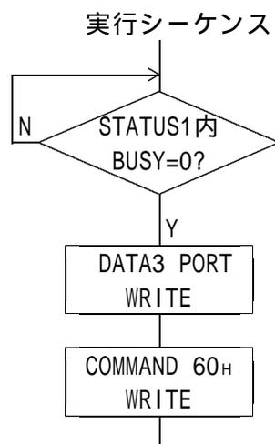
DRIVE DATA3 PORTにSRATEをDATA表のNo.で設定します。
