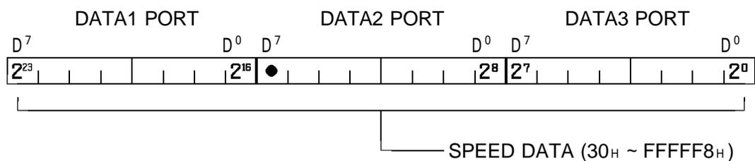
当機能により読み出したDATAより、次式でPULSE SPEEDを算出して下さい。
