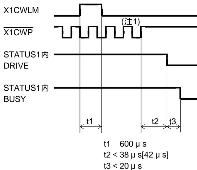
(注1)LIMIT信号を受信してから出力されるPULSE数は定速DRIVEの場合1PULSE以内、加減速DRIVEの場合、減速停止に必要なPULSE数となります。
