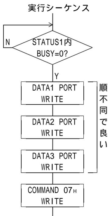
DRIVE DATA1,2,3 PORTにLSPDをHz単位の3バイトDATAで設定します。
