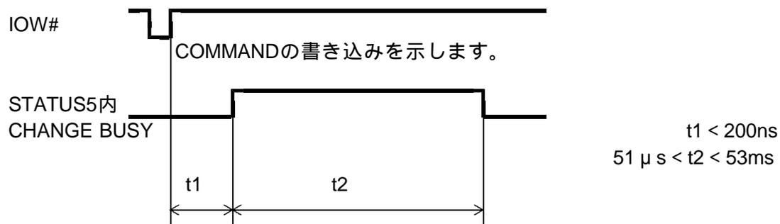
(注)t2は、CHANGE COMMAND書き込み時に設定されているRATEにより変化します。
