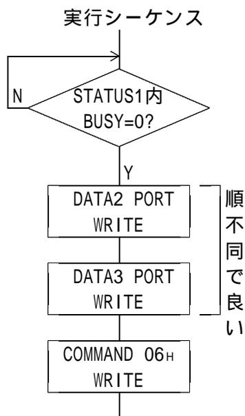
DRIVE DATA2 PORTにURATE、DRIVE DATA3 PORTにDRATEをDATA表のNo.で設定します。
