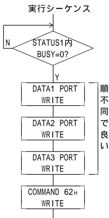
DRIVE DATA1,2,3 PORTにSHSPDをHz単位の3バイトDATAで設定します。
