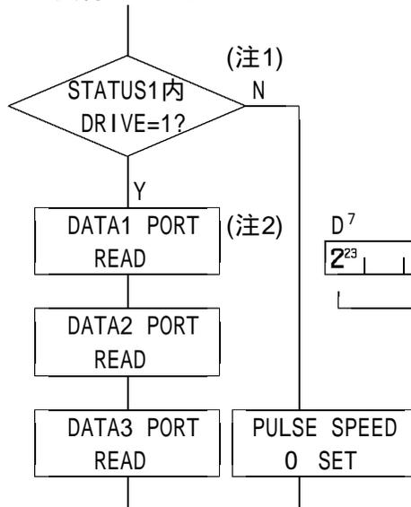
SPEED PORT SELECT後のDRIVE DATA1,2,3 PORTより現在SPEED DATAを読み出します。
