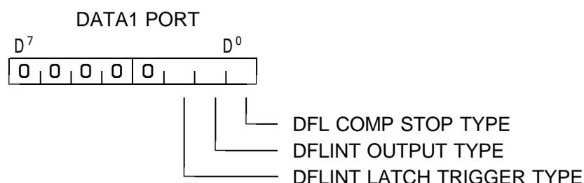
(注) D<sup>7</sup> ~ D<sup>3</sup> BITは応用機能が割り付けられていますので、0として下さい。
