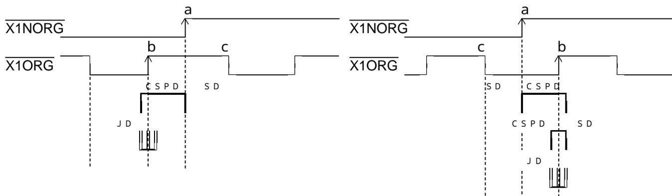
2つのセンサで行う型式です。X1NORG信号の+(CW)側エッジ(a点)を検出した後、X1ORG信号の+(CW)側エッジ(b点)を検出します。NORGセンサは、1つのパルス又は-(CCW)側レベル保持のもの、ORGセンサは回転軸のスリット等周期的に信号発生されるものを使用します。
