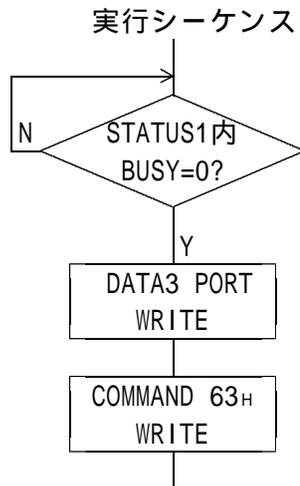
DRIVE DATA3 PORTにSSRATEをDATA表のNo.で設定します。
