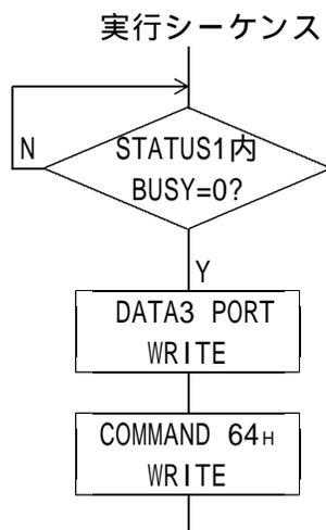
DRIVE DATA3 PORTにSERATEをDATA表のNo.で設定します。
