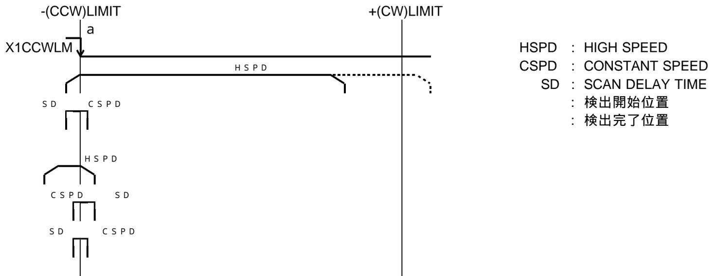
1つのセンサで行う型式です。X1CCWLM信号の+(CW)側エッジ(a点)を検出します。ORGセンサとして、-(CCW)LIMITセンサを使用します。X1CCWLM信号は、1つのパルス又はレベル保持のものを使用して下さい。
