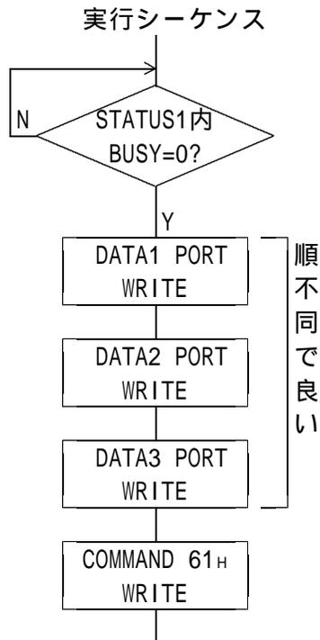
DRIVE DATA1,2,3 PORTにSLSPDをHz単位の3バイトDATAで設定します。
