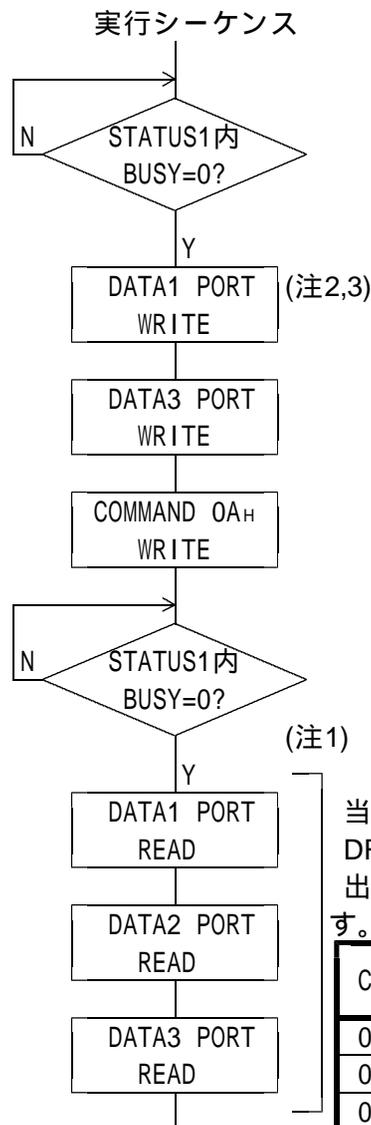
DRIVE DATA3 PORT(WRITE)に読み出しを行いたい設定DATAのCOMMANDを指定します。一部DRIVE DATA1 PORT(WRITE)を使用します。(注2,3)
