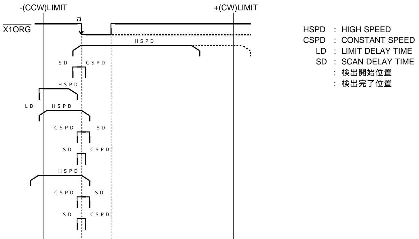
1つのセンサで行う型式です。 $\overline{X1ORG}$ 信号の $-(CCW)$ 側エッジ(a点)を検出します。ORGセンサは、1つのパルス又は、 $+(CW)$ 側レベル保持のものを使用します。
