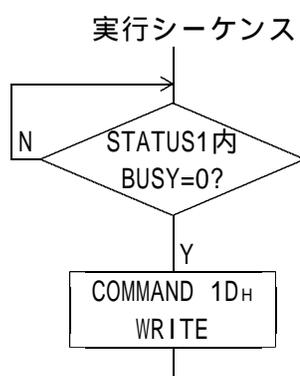
当COMMANDは機械原点検出DRIVE使用時、機械原点近傍までの
