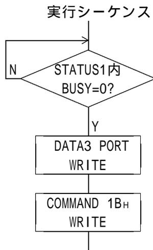
DRIVE DATA3 PORTにOFFSET PULSE数を設定します。
