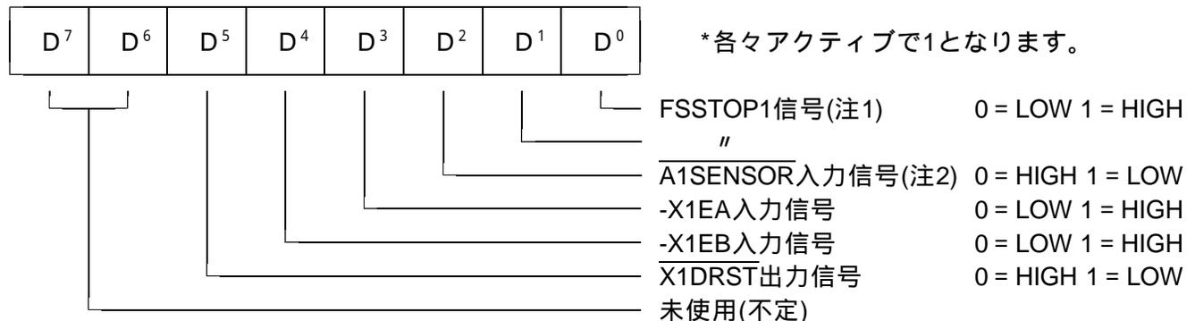
(注1)X1軸～A1軸はFSSTOP1信号が、X2軸～A2軸はFSSTOP2信号が割り付けられています。
