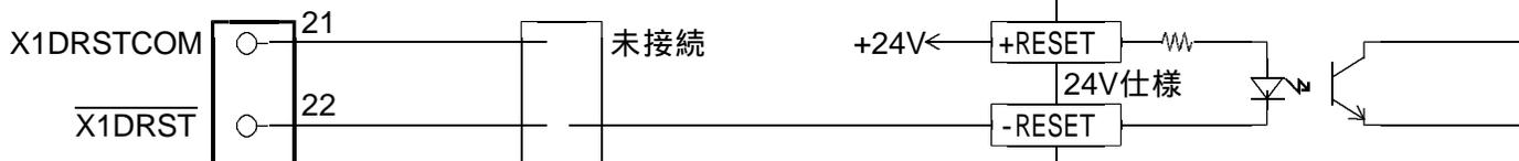
(注4)SERVO DRIVERのエンコーダZ相出力がオープンコレクタ出力の場合の接続例
