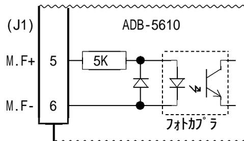
フォトカプラONでモータ出力電流を遮断します。
