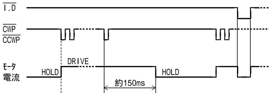
ドライブパルス入力によりモータへの出力電流が HOLD電流から DRIVE電流に切り替わり、パルス停止から約150ms後に HOLD電流に戻ります。
