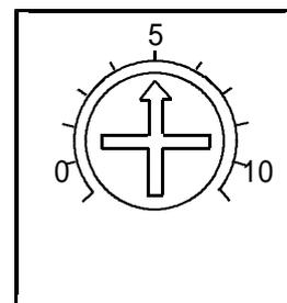
HOLD電流は DRIVE電流の設定値に連動して変化します。
