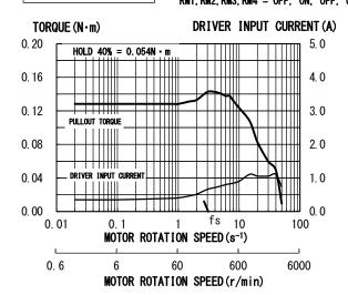
Fig. 7 GDB-5K40 PK566H-A(B) \_\_\_\_\_1.4A/PHASE
