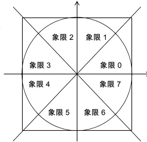
■ 円弧補間ドライブ短軸パルスの軌跡 (CCW 回転の例)
