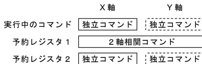
以下の 2 軸相関コマンド実行中は、相関軸のどちらの軸で停止指令が発生しても有効になります。
