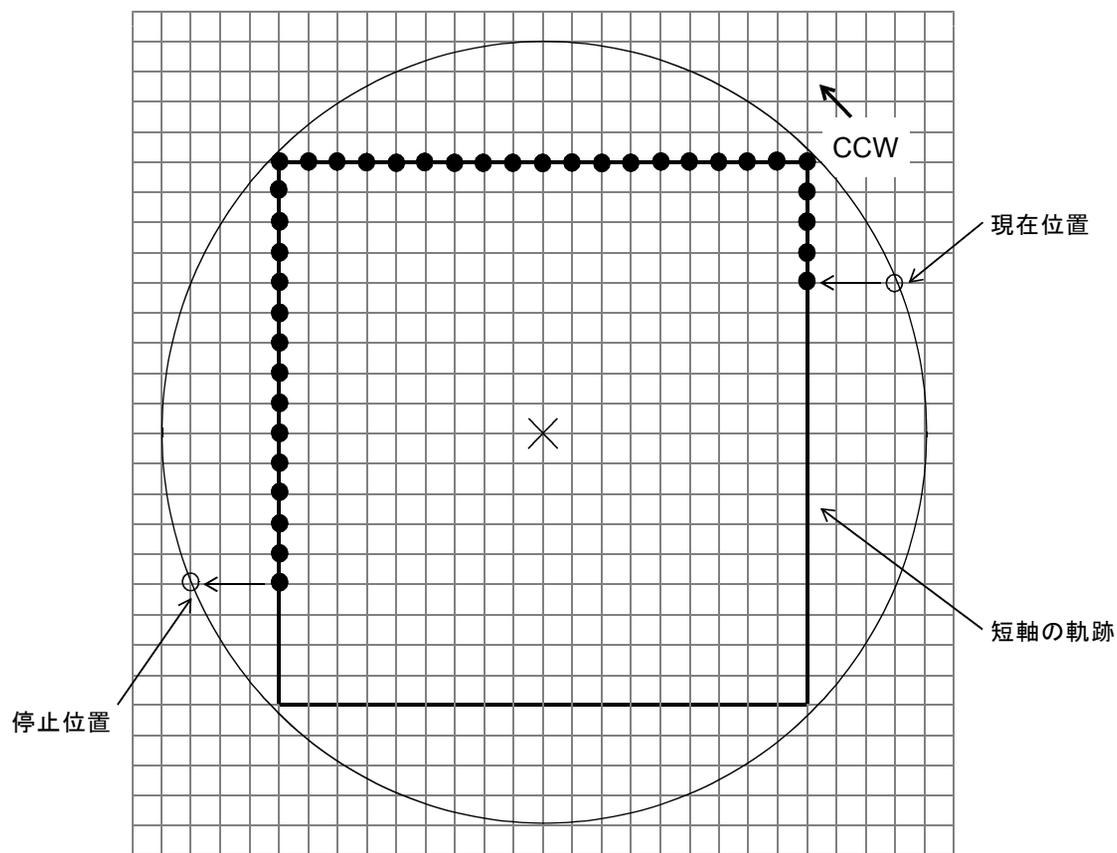
円弧補間ドライブは、円弧の中心座標からみた短軸側が補間ドライブの基本パルス(短軸パルス)を常に出力し、長軸側は基本パルス(短軸パルス)を補間演算して補間パルスを出力します。
