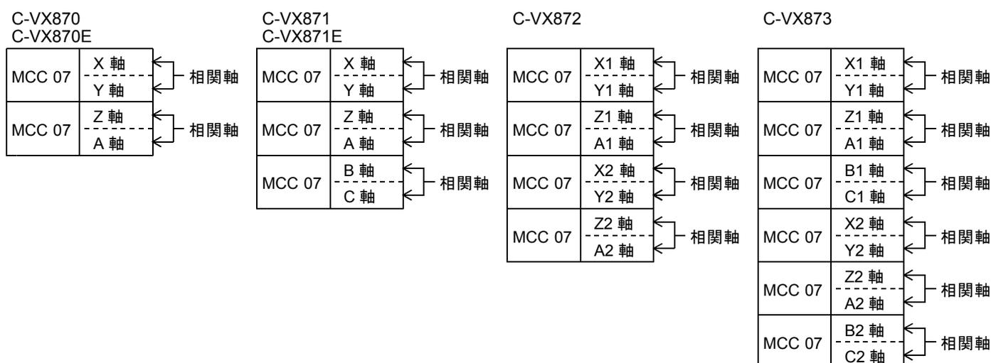
相関軸で 2 軸直線補間ドライブ、および 2 軸円弧補間ドライブが行えます。
