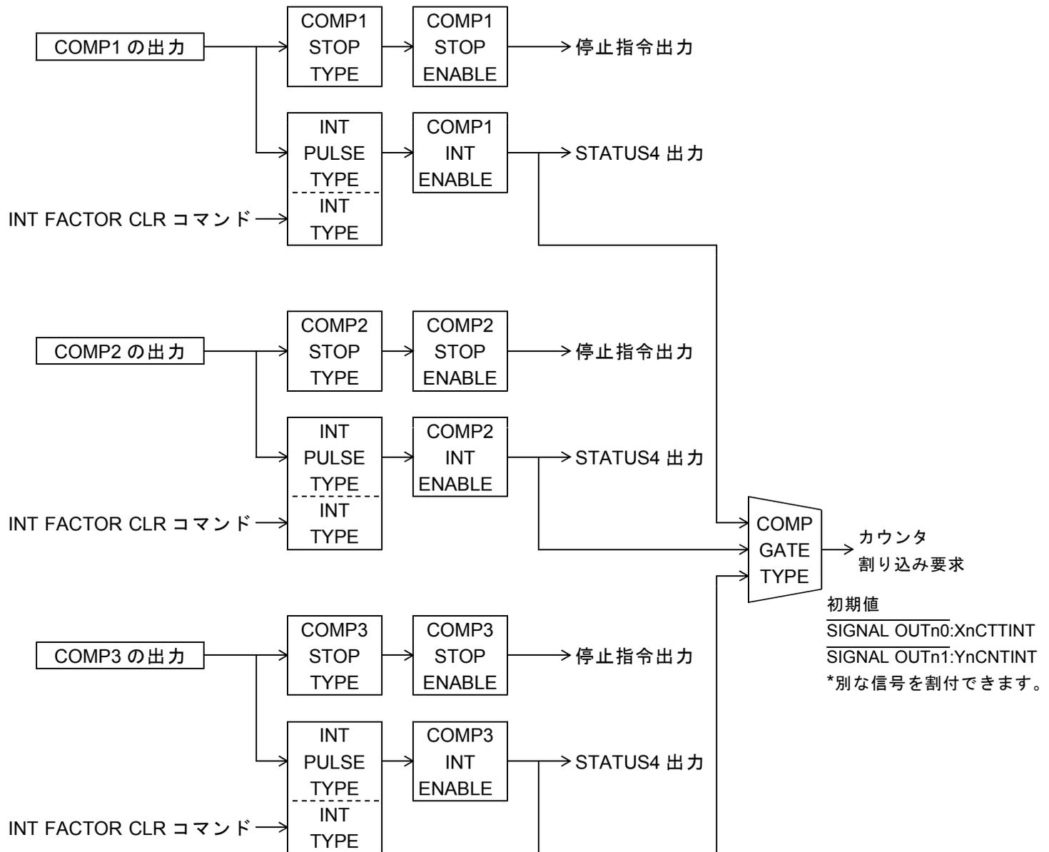
・コンパレータ出力機能は各カウンタ COUNTER INITIALIZE1, 2 コマンドで設定します。
