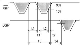
$t1 \ge 1.45 \,\mu \,s$ ,  $t2 \ge 1.45 \,\mu \,s$ ,  $tf, tr \le 2 \,\mu \,s$  $t3 > 2.9 \,\mu \,s$ ,  $t4 > 4 \,\mu \,s$
