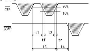
$t1 \ge 0.5 \mu s$ ,  $t2 \ge 0.5 \mu s$ ,  $tf, tr \le 1 \mu s$  $t3 > 1 \mu s$ ,  $t4 > 1 \mu s$
