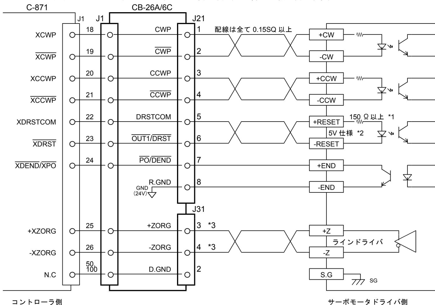
\*1 ドライバ側入力回路の電流制限抵抗が 150 Ω 以下の場合、外部で抵抗を付け 150 Ω 以上にしてください。
