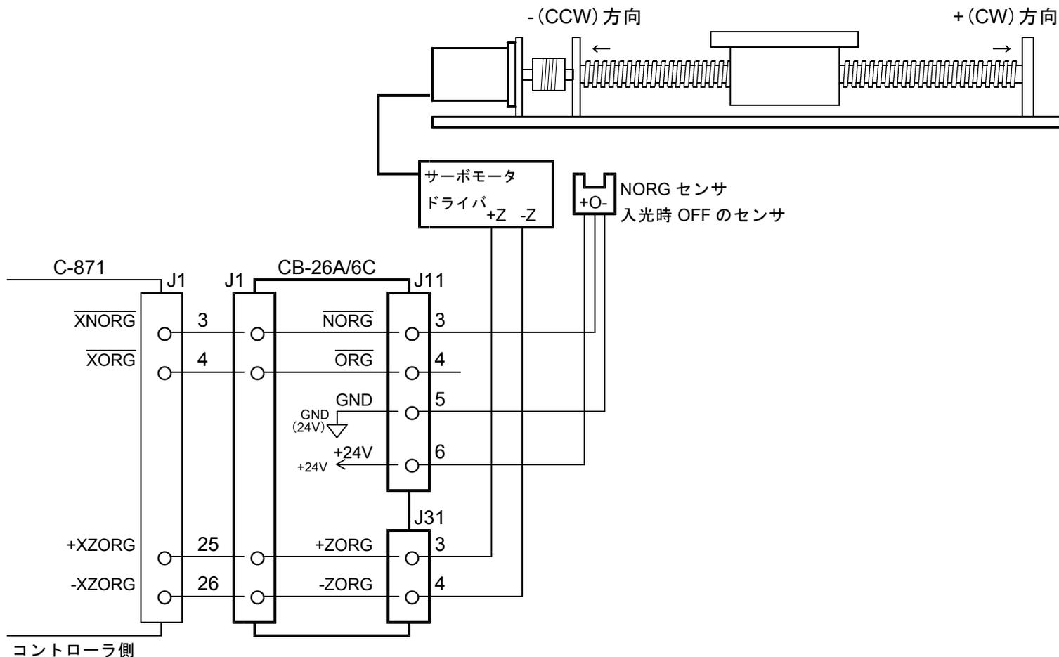
●ステッピングモータドライバのPO信号使用時
