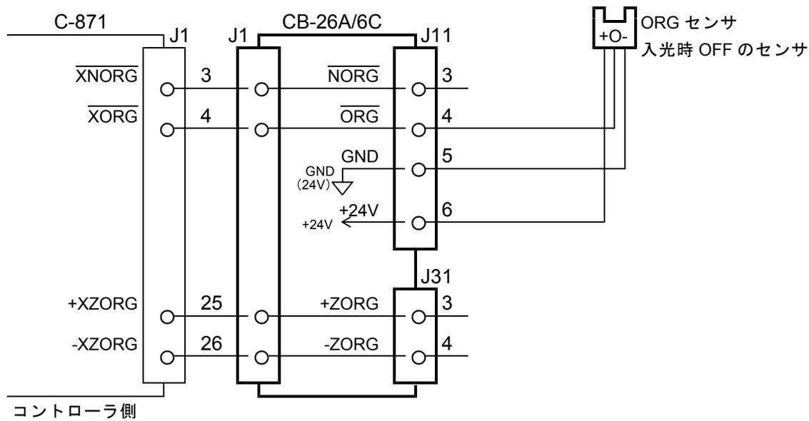
● 原点センサ+原点近傍センサ使用時
