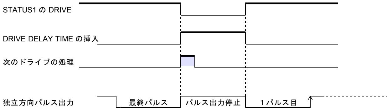
サーボモータ指定の場合は、DEND 信号のアクティブ検出後に DRIVE DELAY TIME を挿入します。
