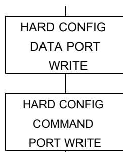
① HARD CONFIG DATA PORT に SIGNAL IN3--0 に入力する信号と軸を選択したデータを書き込みます。
