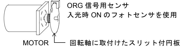
※ ORG-4 または ORG-5 では ORG センサと STEPPING MOTOR DRIVER の PO(相出力)信号を使用して、ORG 信号と PO 信号の AND(論理積)信号により、精度の高い原点検出を行うことが可能です。
