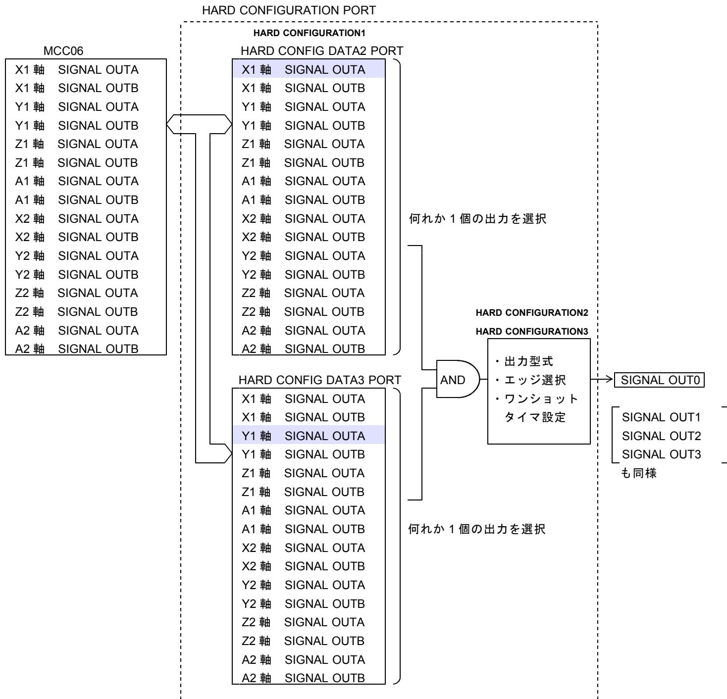
◆ HARD CONFIGURATION1 コマンドで HARD CONFIG DATA2 PORT と HARD CONFIG DATA3 PORT 間で AND 条件が設定されます。
