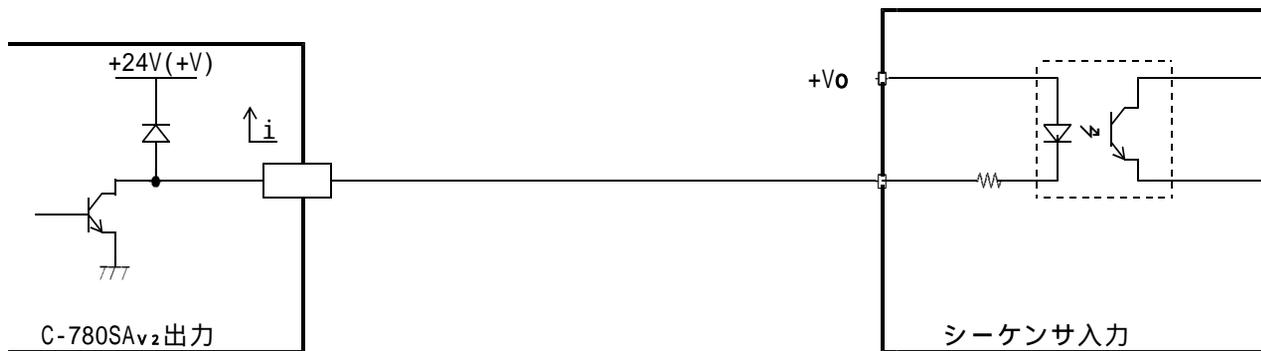
シーケンサへの供給電源(+Vo) > C-780SA<sub>v2</sub>への供給電源(+V)となると出力回路の保護ダイオードを通してリーク電流  $i$  が流れる為、シーケンサ入力が常にON状態となります。
