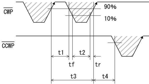
$t1 \geq 0.5 \mu s, \quad t2 \geq 0.5 \mu s, \quad t_f, t_r \leq 1 \mu s$
